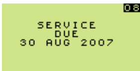
Fig. 3.23 Service Due Date
